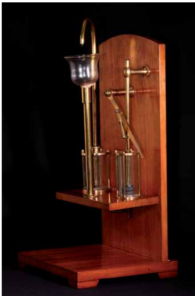
Ponpa xurgatzaile eta bultzatzailea (AZT-0072). 1996an zaharberritua. Bomba aspirante e impelente (AZT-0072). Restaurada en 1996.
